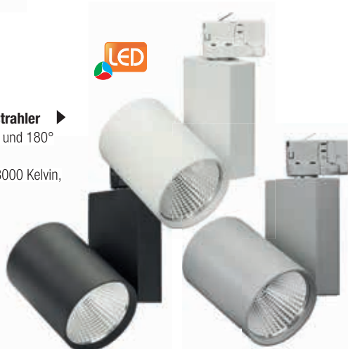
architec LED 3-Phasen Stromschienenstrahler Aluminium, Glas transparent, 335° drehbar und 90° schwenkbar, Abstrahlwinkel 37°, CRI>90, integriertes Betriebsgerät, ØxH 9x20 cm, 28 Watt, 2500 Lumen, 3000 Kelvin, EEK A++ bis A
