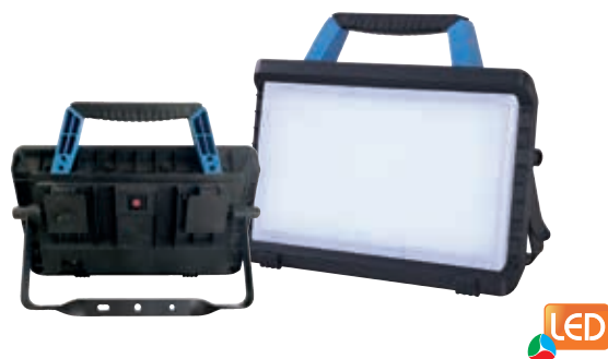
▲ LED-Arbeitsstrahler mit Akku IP54, Kunststoff Gehäuse, Ladezeit: 5 - 6 Stunden, Betriebszeit: 2,5h (bei maximaler Helligkeit), Batterie: Li-Ionen Akku (11,1V/4.4Ah), inklusive Netzteil, Akku: Li-Ionen-Batterie, 4400 mAh, kein Memory-Effekt, 30 Watt, Helligkeitsschalter 50/100%, max. 2100 Lumen, 6500 Kelvin Art.-Nr. 055943 164,95 €
