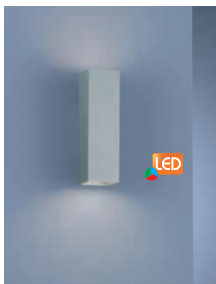
BÖHMER LED-Wandleuchte Metall pulverbeschichtet, Abstrahlung nach oben und unten, HxBxT 21x6x9 cm, inklusive LED 2x GU10 7 Watt, tauschbar, warmweiß, 700 Lumen, EEK A+ weiß Art.-Nr. 881483 169,95 € titan-silber Art.-Nr. 881484 169,95 €
