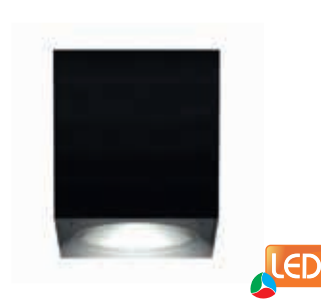
RZB LED-Deckenleuchte IP54, anthrazit metallic, Aluminiumdruckguss, Abdeckung Glas klar, ØxH 9x9,5 cm, 8,6 Watt, 570 Lumen, 3000 Kelvin, inklusive LED, nicht tauschbar, EEK A+ Art.-Nr. 664449 137,95 €
