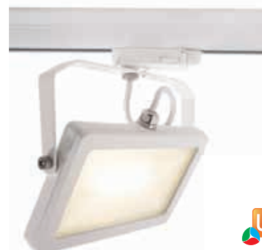
LED 3-Phasen Stromschienenstrahler inkl. Konverter Aluminiumdruckguss weiß-matt, drehbar und schwenkbar, Reflektor Aluminium, inklusive LED, nicht tauschbar LED 15 Watt, LxBxH 17x14x2,7 cm, 100° Abstrahlwinkel:
