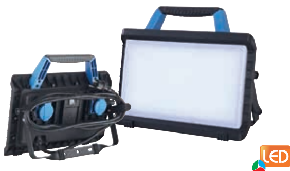
▲ LED-Arbeitsstrahler IP54, Kunststoff Gehäuse, Zuleitung mit Schukostecker 3m, 2 Arbeitsteckdosen: max. 3600 Watt, 45 Watt, Helligkeitsschalter 50/100%, max. 3800 Lumen, 6500 Kelvin Art.-Nr. 055942 149,95 €
